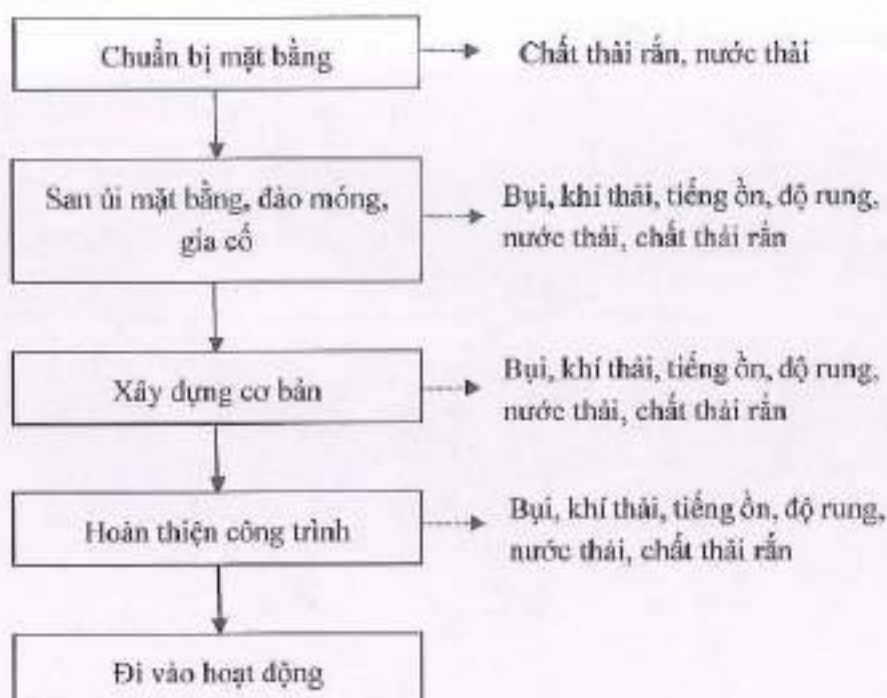
Hình 1. 6. Sơ đồ quy trình thi công
